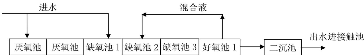
图 2-1-2 MUCT 反应池处理工艺流程图
